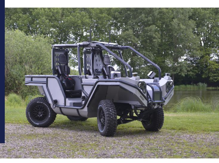
4x4 léger, véhicule tout-terrain à grande vitesse, modulaire avec cabine ouverte.
